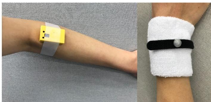
図 5-1: 筋電センサとマーカーの装着図
