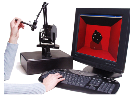
(b) PHANToM (3Dsystem 社) 把持部 (ペンまたは指サック形状) を操作すると、6 自由度の反力を提示可能.
