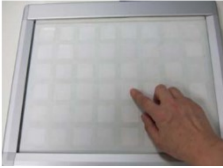
(a) 温度ディスプレイ (Thermoesthesia) 概観 48 個のペルチェ素子を配列した 15 インチ温度 ディスプレイ.
