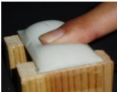
(a) 遭遇型の接触面積制御装置 (池田, 藤田 2004) 空気圧でゴム膜を制御することで、皮膚との接触面積 を操作する.
