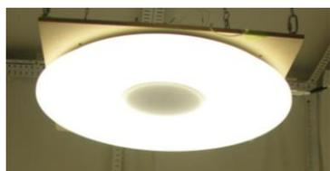
(a) 実験室 A 及び実験室 B で用いる LED シーリングライト
